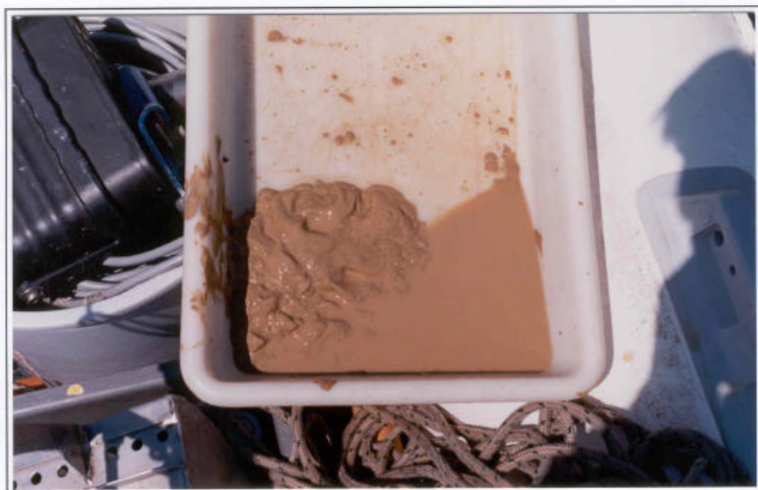
Sedimento limoso extraído del embalse de Camarasa, en las cercanías de la presa.
