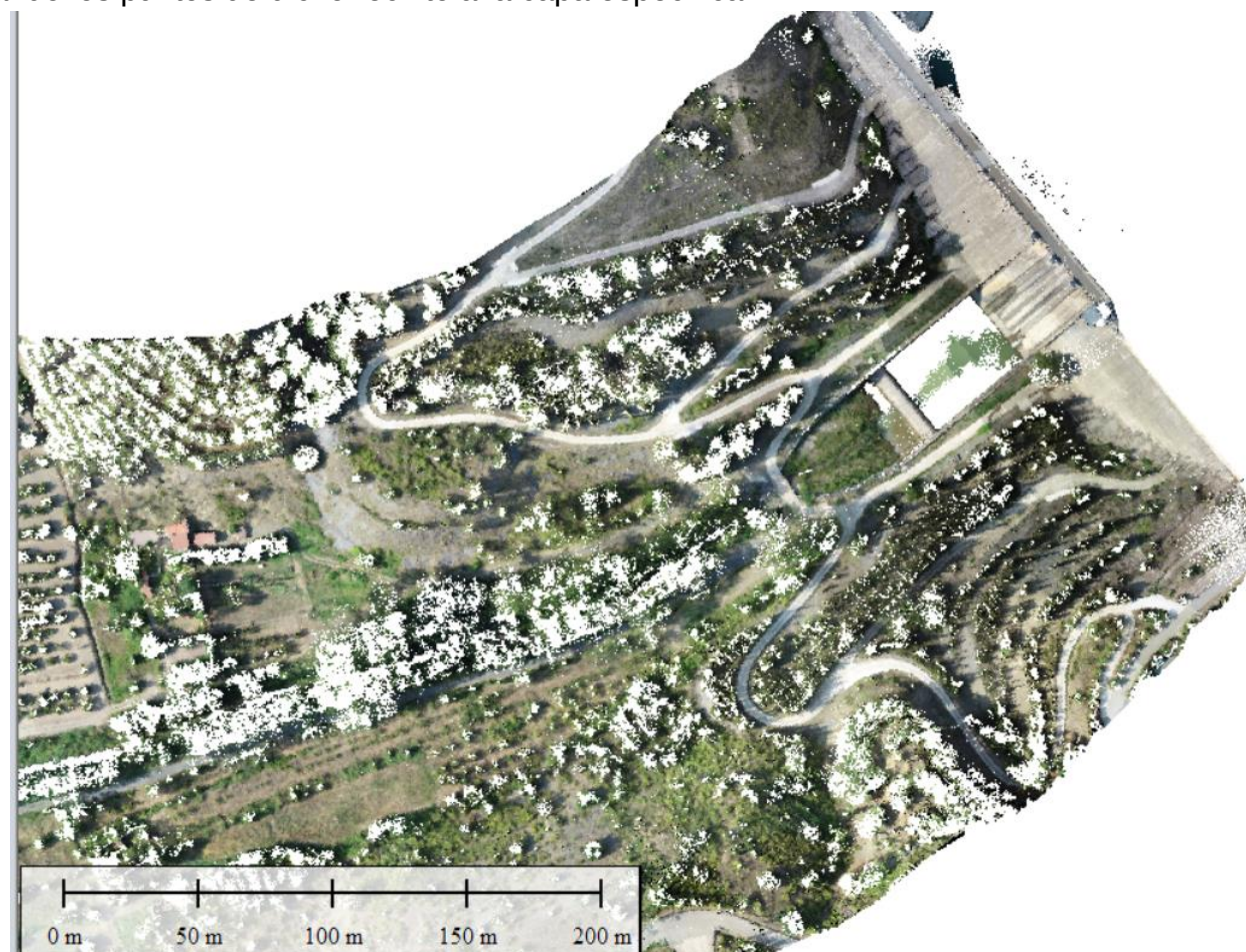
Imagen 3.1.2 Filtrado de arbolado y construcciones para DTM
