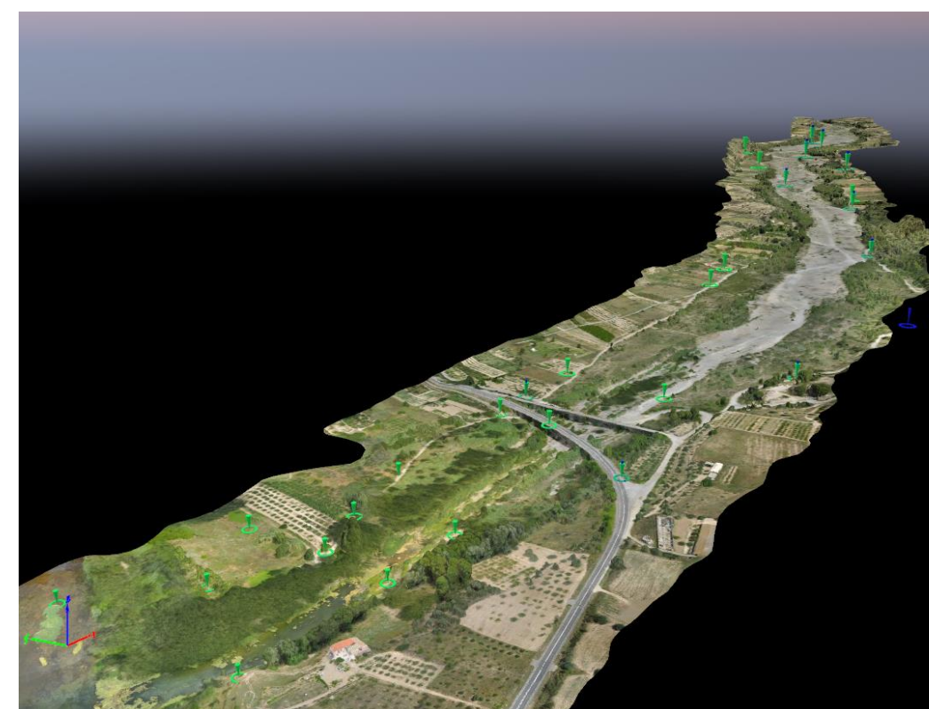
Imagen 2.5.2 Posición de los puntos de apoyo sobre la zona de vuelo en PIX4
