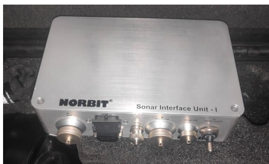
Figura 40 Unidad de cubierta SIU (Sonar Interface Unit)
