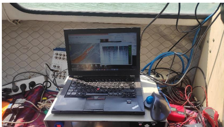
Figura 67 Sistema de adquisición y navegación durante el levantamiento sísmico.
