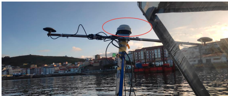
Figura 33 Embarcación con el mástil dónde se instala la antena GPS Rover
