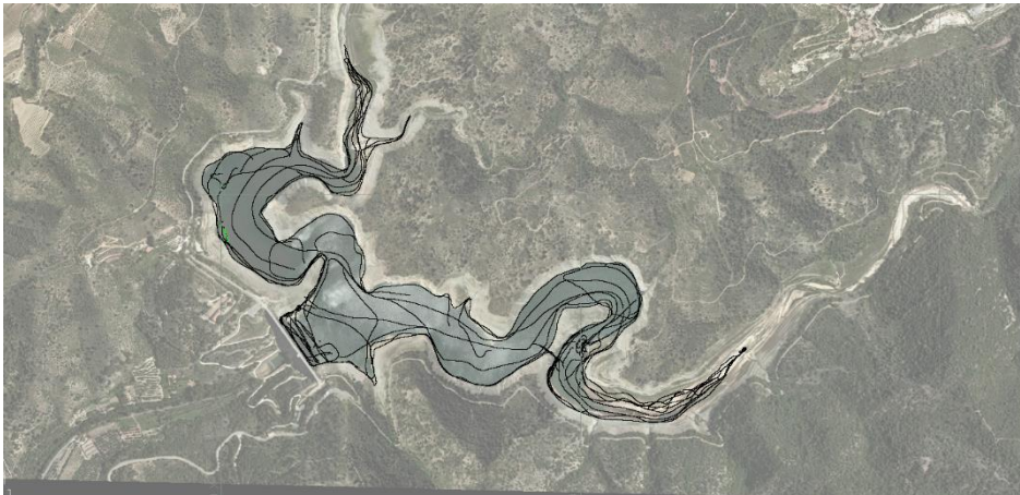
Figura 65 Navegación realizada para el levantamiento batimétrico y topográfico
