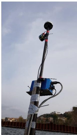
Figura 43 Velodyne VLP16 integrado en el mástil junto a la ecosonda y al sistema MRU+GPS RTK.
