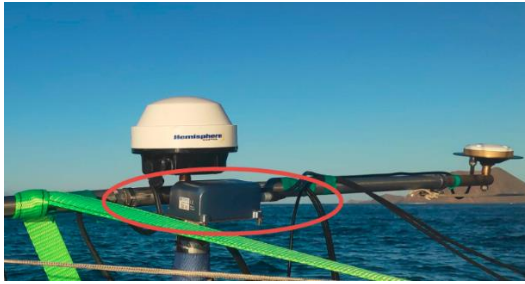
Figura 21. Sensor de movimiento y GPS integrado en el soporte de la ecosonda multihaz.
