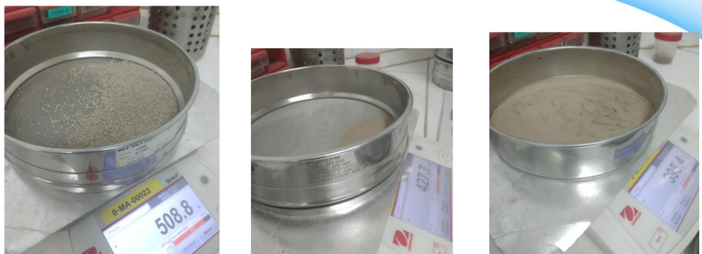
Figura 95 Pesaje de los distintos tamices.
