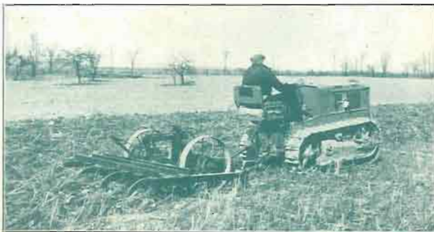
"CATERPILLAR" 2 TONELADAS CON CULTIVADOR-ESCARIFICADOR "KILLEFER", DE 1.50 M. DE ANCHO
